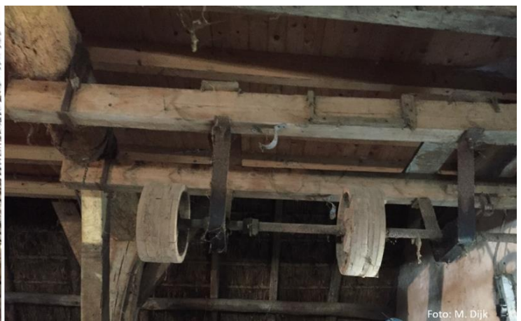
De nog aanwezige cirkel voor de tredmolen voor de karn, aan gedreven door een kidde [klein paard] tevens, nog in de stal aanwezige riem aandrijving voor wanmolen of bietensnij machine.
